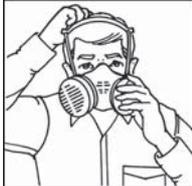
Nach dem Aufsetzen der Halbmaske über Mund und Nase, ist die Kopfbänderung gemäß der Abbildung anzulegen.
