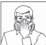
**Überprüfung durch Überdruck:** Legen Sie die Handfläche über das Ausatemventil und atmen Sie langsam aus. Wenn keine Luft zwischen dem Maskenkörper und dem Gesicht entweicht, wurde ein ordnungsgemäßer Sitz erzielt. Ansonsten muß der Maskensitz oder die Spannung der Bänder korrigiert werden.
