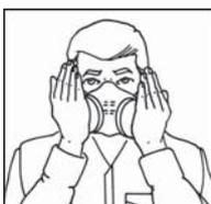
**Überprüfung durch Unterdruck:** Verschließen Sie die Öffnungen der Filtergehäuse mit der Handfläche und atmen Sie langsam ein. Wenn sich der Maskenkörper leicht zusammenzieht, wurde ein ordnungsgemäßer Sitz erzielt. Ansonsten muß der Maskensitz oder die Spannung der Bänder korrigiert werden.
